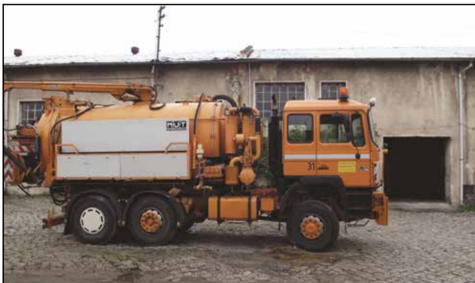
Marka Man - samochód uniwersalny pojazd ssąco-tłoczący typu WUKO służy do udrażniania i czyszczenia kanalizacji sanitarnej i deszczowej oraz wywozu nieczystości płynnych przystosowany również do zimowego utrzymania dróg.
